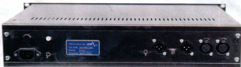
La face arrière, avec entre autres les connecteurs XLR d'entrée/sortie et un sélecteur de levage de masse.
